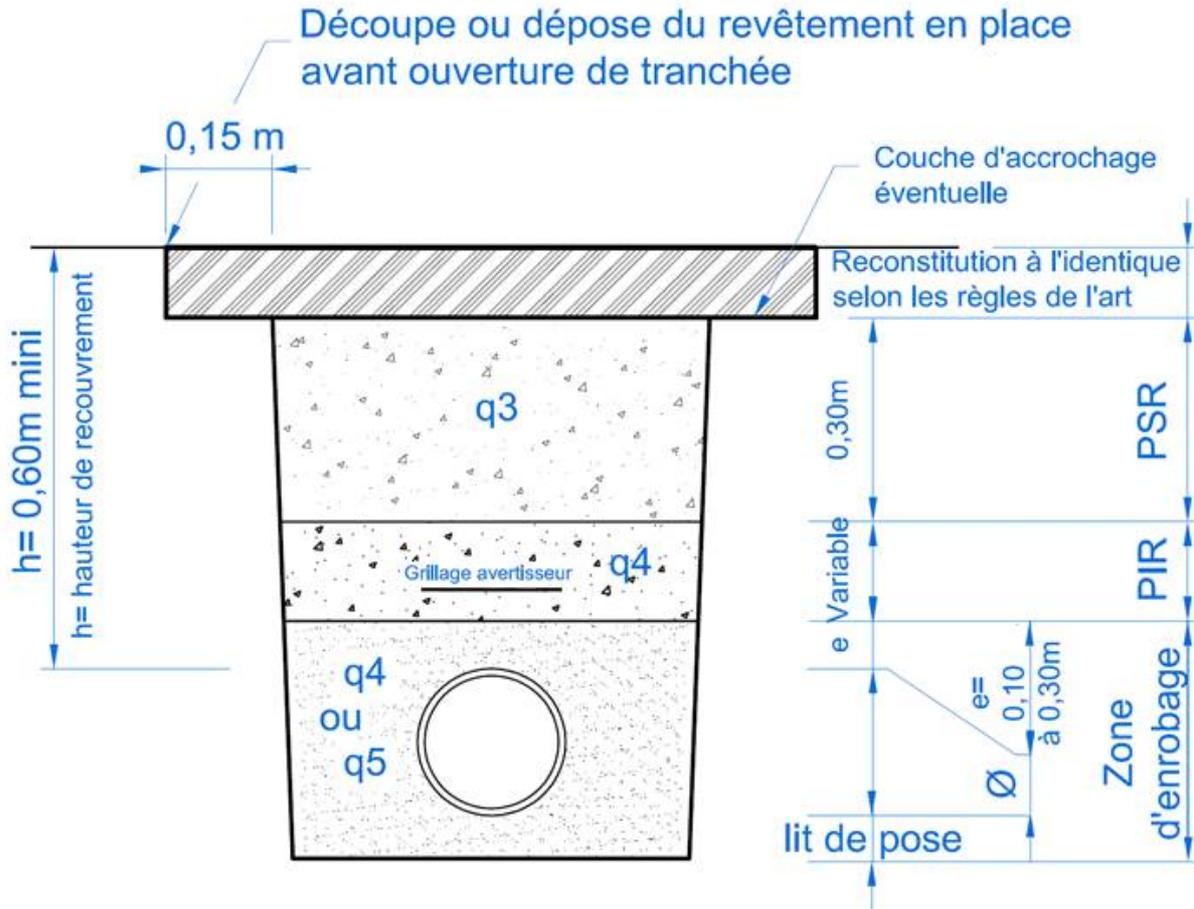
**Le remblayage des tranchées classiques sous accotement non revêtu** (hors chaussée) doit être effectué conformément à la fiche n°5 annexée à la présente autorisation.
