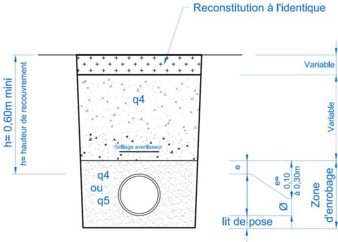
**Le remblayage des tranchées classiques étroites sous chaussée** situées sur le réseau départemental de catégories R1+, R1, R2, R3, R4 doit être effectué conformément à la fiche n°6 annexée à la présente autorisation.
