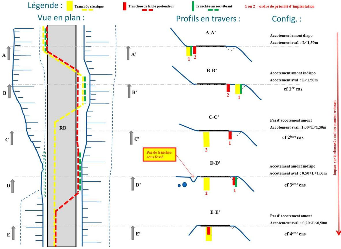
Les tranchées longitudinales sous chaussée doivent être implantées, en priorité, hors passage des roues des véhicules, en principe dans l'axe des voies de circulation (cf annexe n°5).
